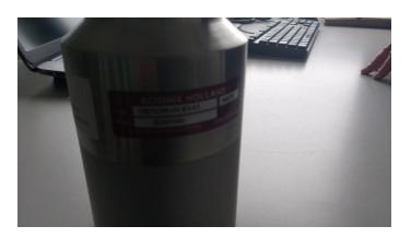
Fig. 2. SCIONIX - Nal(TI) detector
